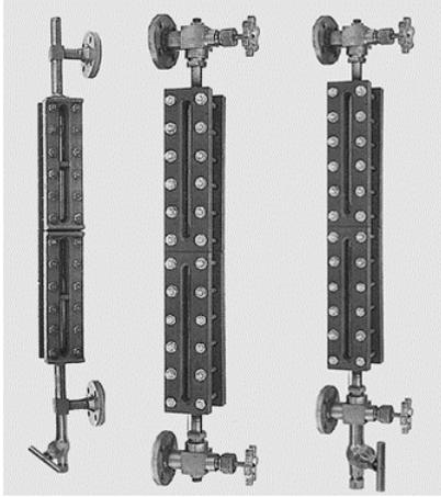
YSU、UBS 系列双色玻璃板液位计是 UB 型玻璃板液位计的更新产品，仪表气液相双色显示，观察清晰，采用不锈钢和 F4 密封填料制造，耐腐蚀性好。它广泛用于工业系统中敞开或密闭容器内介质的液位指示，特别是无色透明液体的现场指示。
