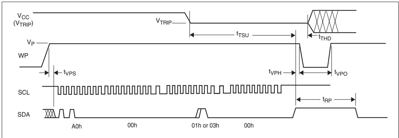
**$V_{TRIP}$  Programming Parameters**
