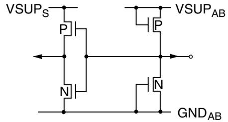
**Fig. 6-29:** Input pins P42-P46
