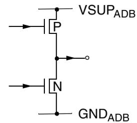
**Fig. 6-30:** Output pins ADB0-ADB18,  $\overline{OE1}$ ,  $\overline{OE2}$ ,  $\overline{WE1}$ ,  $\overline{WE2}$
