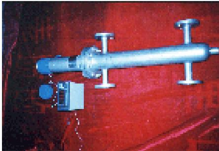
主要适用于各类锅炉、锅筒液位的检测，同时适用于其它中、低压容器和开口容器化工原料的液位检测，该变送器由DC24V电源供电，二线回路，4-20mA信号输出，可与各种显示调节仪表配合使用，能实现水位显示，高低极限报警、水位的连续自动调节，以确保锅炉的安全运行。
