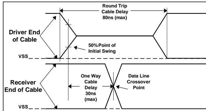
**FIGURE 6 - CABLE DELAY**
