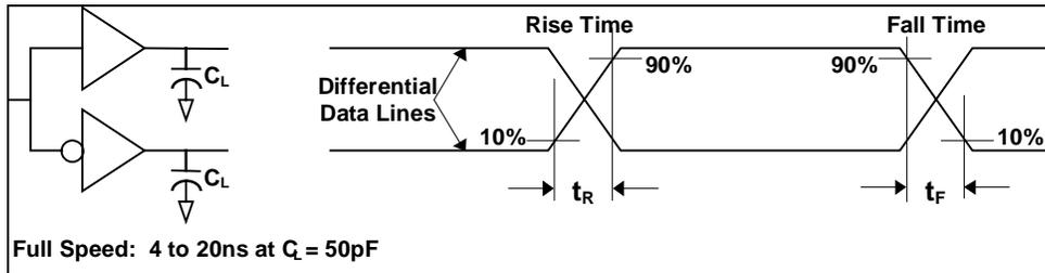
**FIGURE 5 - DATA SIGNAL RISE AND FALL TIME**
