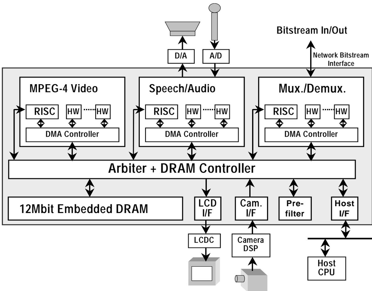
Fig. 1 Block Diagram
