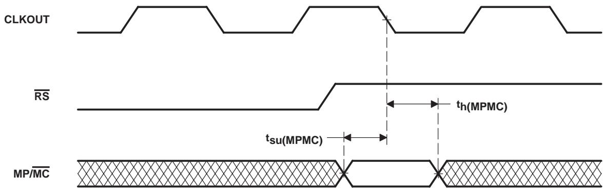
Figure 4-17.  $\overline{\text{MP}}/\overline{\text{MC}}$  Timing
