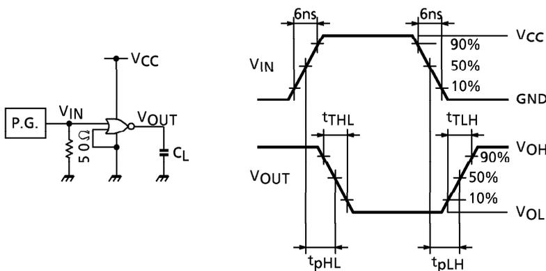
**I<sub>CC(opr)</sub> TEST CIRCUIT**
