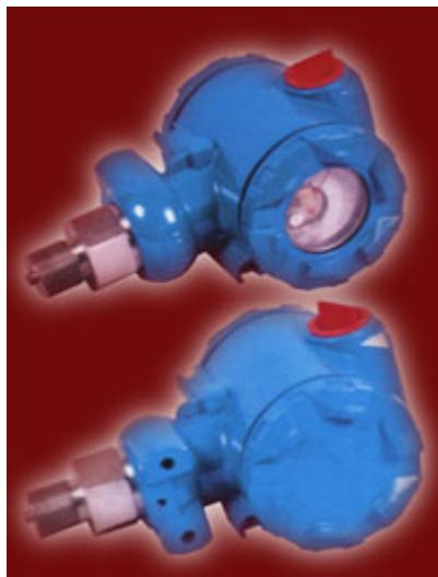
系列工业压力传感器是本所利用进口充油隔离组织，把固态集成工艺与隔离膜片技术、激光微调的温度补偿电阻技术结合在一起，扩散硅芯片被安装在充满硅油的圆柱体腔体内，通过不锈钢膜片和外壳把其与测量介质隔离开。产品被设计成可在恶劣环境下工作，而硅敏感元件仍然保持其优良的灵敏度、线性度和滞后。采用一体化温度补偿技术，信号再经精密温度补偿，放大处理转换成4~20mA或1~5V标准信号。可与DDZ系列仪表以及工业计算机或集散系统接口，实现生产过程的自动测量和控制。可广泛应用于石油、化工、冶金、电力、轻工、建材、科研等领域。是工业过程控制的首选产品。
