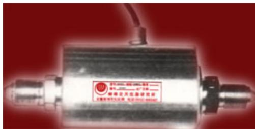
**SM24K05**系列隔离差压传感器采用进口芯片正负压力腔充硅油，两端用电子束焊接不锈钢膜片进行隔离，采用不锈钢外壳进行封装。敏感芯片由做有扩散硅电阻桥的硅膜片和玻璃支撑环静封而成，经精密的温度补偿，使其具有良好的长期稳定性和温度稳定性。产品可广泛用于石油、化工、电力、冶金等恶劣的工业现场和有腐蚀介质的差压流量测量和控制。
