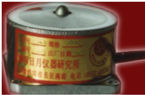
SM27型称重传感器系采用先进的扩散硅工艺制作的半导体应变片做为力—电转换元件。输出信号大，蠕变小，温漂时漂小，使用寿命长。与国内同类产品相比具有较高的质量/价格比。目前已成功地广泛应用于建材、水泥等
