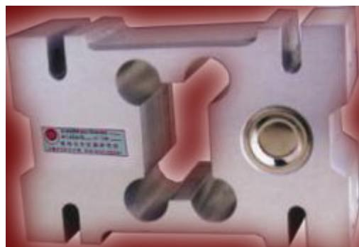
SM18H-F型系列称重传感器为双孔平行悬臂梁式结构，是采用进口原材料及美国BEAN公司专有加工技术生产的敏感元件制造的高精度箱式结构称重传感器。在制作出厂时已通过温度补偿，四角调整，保证其在规定受载平面内各点输出一致。可用于制作由单台传感器构成的各种型式的电子大台面秤、校验秤、配料秤及各种工艺秤、专用秤，产品结构形式简单，高度低，抗侧向能力强，结构紧凑，精度高，使用方便。
