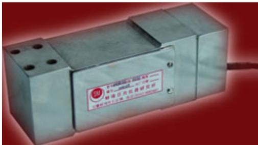
SM18H型标准输出称重传感器为双孔平行悬臂梁式结构，采用进口原材料及美国BEAN公司专有加工技术生产的敏感元件制造的高精度箱式结构称重传感器。在制作出厂时已通过温度补偿、四角调整，保
