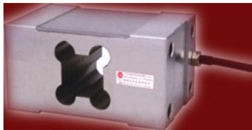
SM18G型标准输出箱式称重传感器，采用进口原材料及美国BEAN公司专有加工技术生产的敏感元件制造的高精度箱式结构称重传感器。在制作出厂时已通过温度补偿、四角调整，保证其在规定受载平面内各点输出一致。可用于制作由
