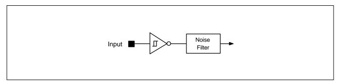
Figure 1-3. Pin Circuit Type 1 (V-Sync H-Sync, CAPA)
