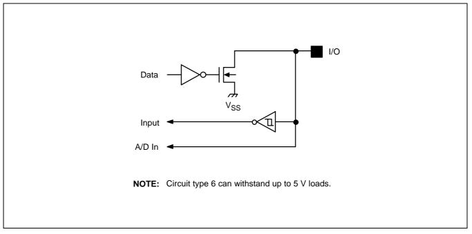
Figure 1-8. Pin Circuit Type 6 (P3.0-P3.1, P0.6-P0.7, ADC0-ADC3)
