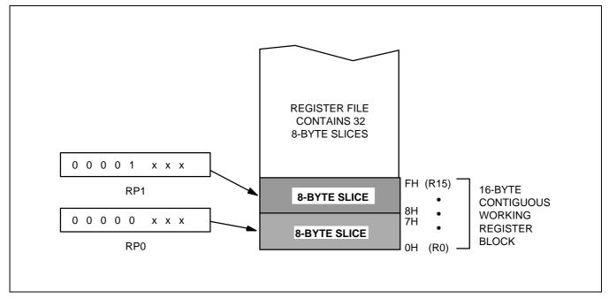
Figure 2-7. Contiguous 16-Byte Working Register Block
