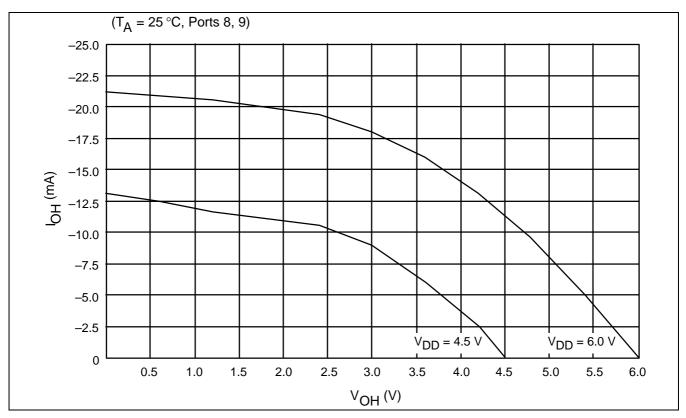
Figure 14-16. I<sub>OH</sub> VS. V<sub>OH</sub> (P8, 9)
