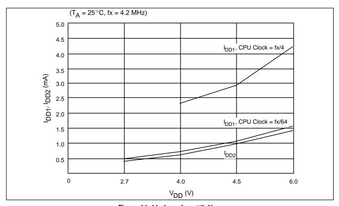
Figure 14-11. I<sub>DD1</sub>, I<sub>DD2</sub> VS. V<sub>DD</sub>
