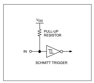
Figure 1-5. Pin Circuit Type B
