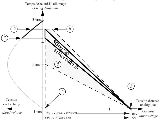
**SG4 : 4-20 mA**
