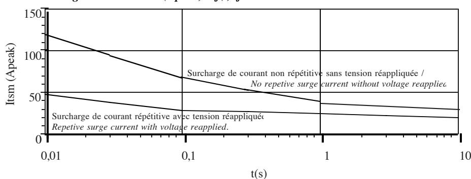
**Fig.3 Surcharge de courant : Itsm (Apeak) = f(t) pour modèle 50A(Its<sub>m</sub>=550A)**
