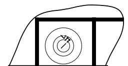
Position du potentiomètre intégré pour un angle initial de  $90^\circ$
