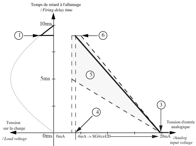
**(1) Préréglage d'usine à  $170^\circ \pm 5\%$  ( $tr=9,44ms$ ), pour les modèles**
