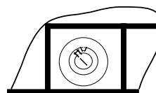
Position du potentiomètre intégré pour un angle initial de  $180^\circ$
