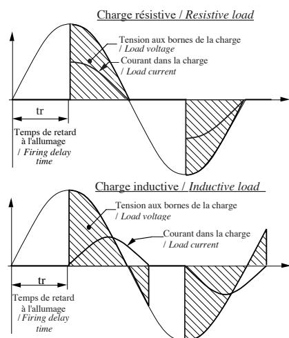
**Valeur efficace de la tension sur une charge résistive (Ucharge en fonction du temps de retard à la commande (tr) / RMS resistive load voltage (U Load) versus delay time control (tr) .**
