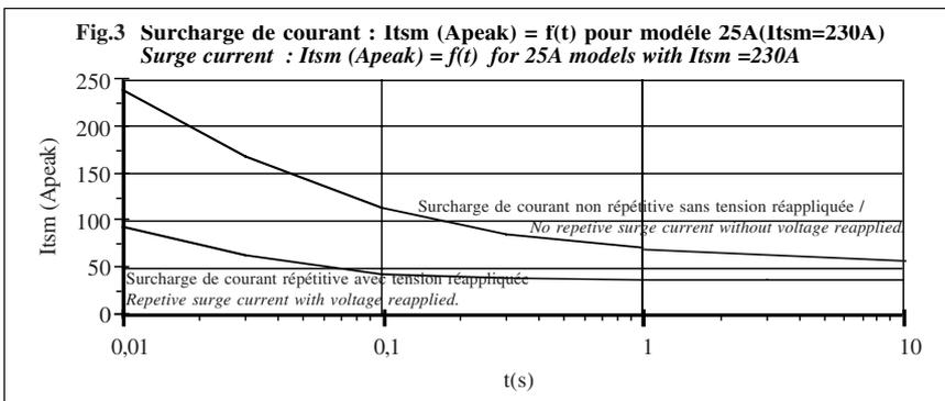
1 -I<sub>tsm</sub> non répétitif sans tension réappliquée est donné pour la détermination des protections.
