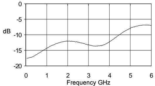
S11,  $I_D=65\text{mA}$ ,  $T_a=25^\circ\text{C}$
