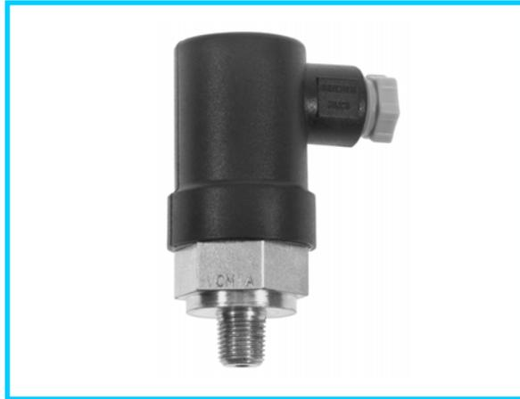
**原理, 结构:** 内置活塞与精密弹簧相连当压力变化时, 弹簧特性发生相应变化, 当压力达到设定值时, 会触发预设的机械结构并发出开关信号。
