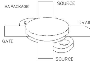
**PATENTED GOLD METALIZED SILICON GATE ENHANCEMENT MOD**
