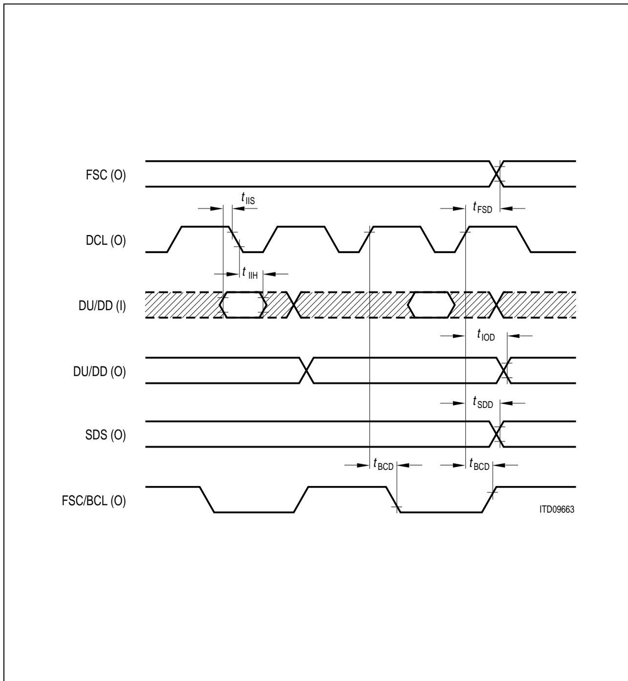
Figure 110 IOM<sup>®</sup> Timing (TE mode)
