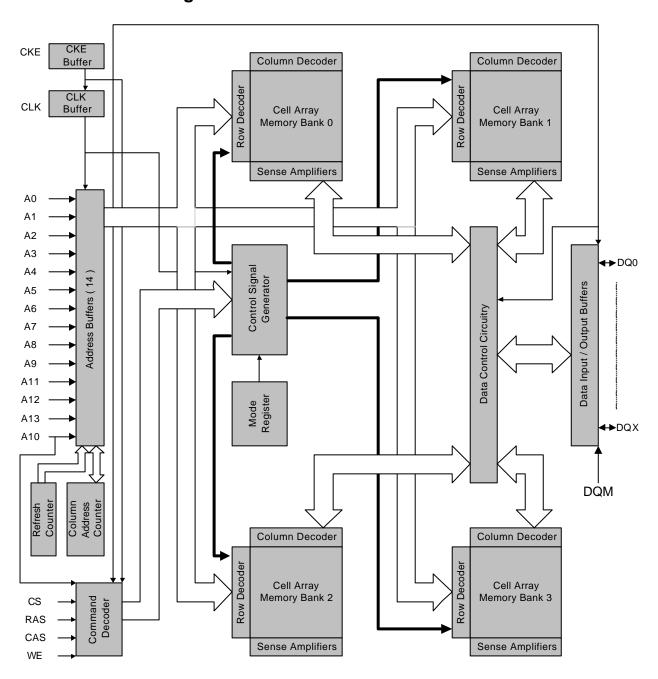
Cell Array, per bank, for 4Mb x 4 DQ : 4096 Row x 1024Col x 4DQ (DQ0-DQ3).
