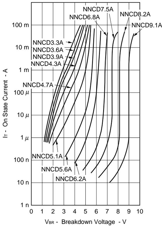
Fig. 4 I<sub>T</sub> - V<sub>BR</sub> CHARACTERISTICS
