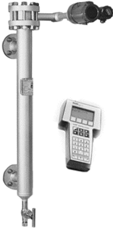
LC3010 系列智能型电动浮筒液位（界位）变送器是美国费希尔控制设备公司与上海星申仪表有限公司合作生产的产品。公司直接引进进口原装 FIELD VUE DLC3000 系列智能型液位控制器，其余部分（含浮筒测量室及测量机构等）由本公司设计制造。仪表可用于测量液位、界位或密度，能输出 4~20mA 标准直流信号，利用 HART 通信协议的 DLC3000 系列智能型液位控制器还可存取对过程操作至关重要的信息。使用与 DLC3000 系列智能液位控制器相兼容的 275 型 HART 通信器，可获得来自过程、智能液位控制器或浮筒测量室的信息。HART 通信器可连接在智能液位控制器的现场接线盒上。由于使用 HART 通信器，用户可查询、组态、标定或测试智能液位器。利用 HART 协议，对来自现场的信息可下载到控制系统中或按单个回路的信息接受。
