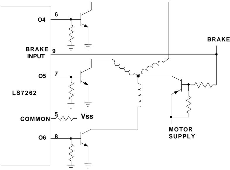
**FIGURE 2A. SINGLE-ENDED DRIVER CIRCUIT**
