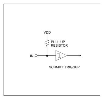
Figure 1-5. Pin Circuit Type B
