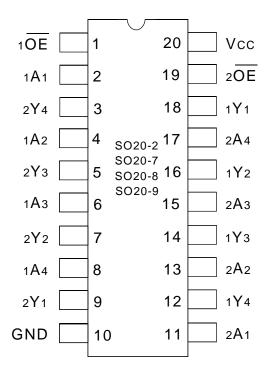
SOIC/ SSOP/ QSOP/ TSSOP TOP VIEW
