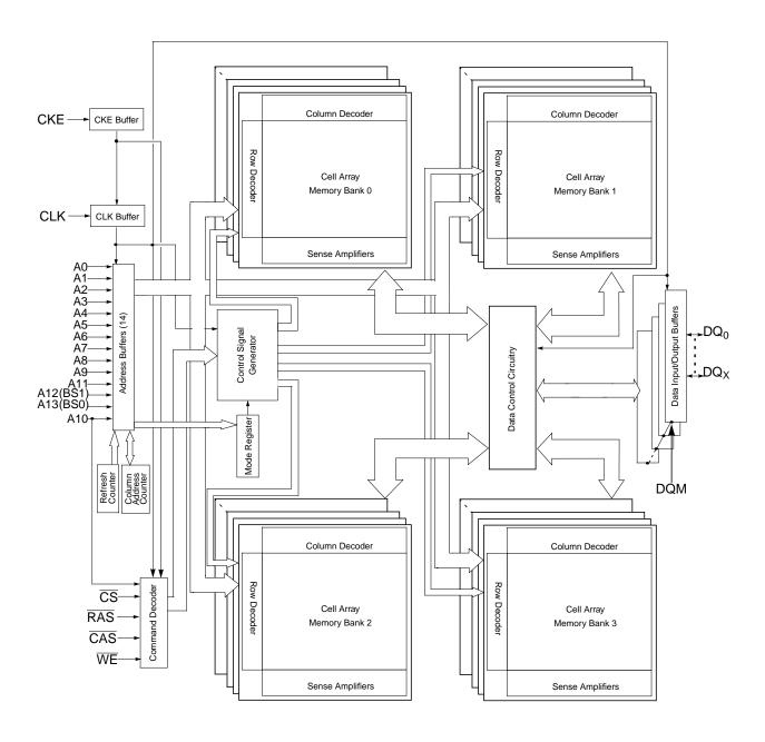
Cell Array for 4Mb x 4 DQ x 4 Bank (per Bank): 4096 Row x 1024 Col x 4 DQ (DQ0-DQ3).
