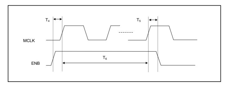
$T_4$ : ENB Setup Time: 5ns  $T_5$ : ENB Hold Time: 5ns
