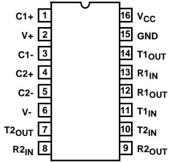
HIN206 (PDIP, SOIC, SSOP)
