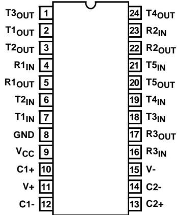
HIN208 (PDIP, SOIC, SSOP)
