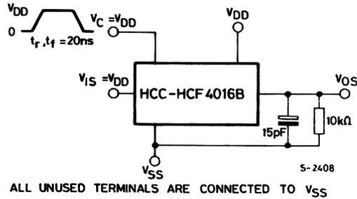
PROPAGATION DELAY TIME SIGNAL INPUT (V<sub>I</sub>) TO SIGNAL OUTPUT (V<sub>O</sub>)
