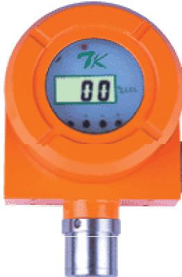
GM-2000C 型可燃性气体传感变送器是中美日三方技术合作之结晶，它采用了日本 NEMOTO 公司原装进口高精度、高灵敏度的工业级催化燃烧式传感器，配有美国 Burr-Brown 公司专用智能集成芯片，由我公司专业技术人员研制而成的。具有世界先进水平的高稳定性的现场气体检测仪表。该仪表主要用来全天候检测危险环境中泄漏的可燃性气体浓度，并输出与被测气体%LEL 浓度值成正比的 4-20mA 标准电流信号，本仪表是 GM-2000B 型仪表基础上进行研究开发的，配备大屏幕 LCD 液晶显示，现场直接显示被检测气体的浓度，具有现场光报警及接点信号输出功能，(可根据用户需求扩展此功能) 实时检测危险场所可燃性气体的泄漏情况，避免危险事故的发生，现场采用按扭调校零点及量程、方便可靠。可与我公司提供的 GM-1000X□、GM-1000A 系列显示报警控制器构成一套可燃性气体检测报警控制系统，也可与 DCS 和 PLC 等设备或其他数据采集系统组成一整套完整的气体检测报警控制系统，是石油化工、油田、油库、制药、制冷、环保、消防、市政、液化气站等存在可燃性气体场所的安全卫士。
