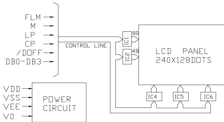
注释: 当信号线直接连到 C - MOS 电路且没有内部上拉或下拉电阻时 ,有必要隔离外部干扰来保护信号线。
