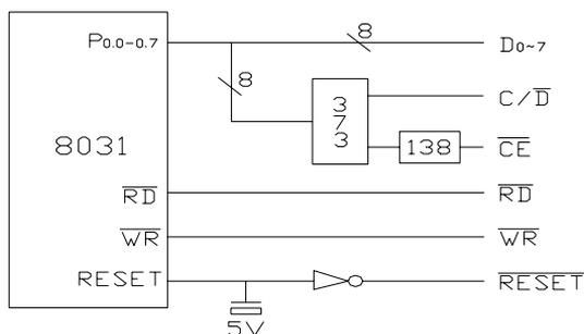
8031 数据口 P0 口直接与液晶显示模块的数据口连接，8031 的 RD，WR 作为液晶显示模块的读，写控制信号，液晶显示模块 RESET，挂在+5V 上。CE 信号可由地址线译码或由 MREQ，IORQ 共同产生。例如，取 138 译码器 Y0 输出（单独测试时可将 CE 端直接接地）。C/D 信号可由 8031 地址线 A0 提供，A0=1 为指令口地址；A0=0 为数据口地址。各驱动子程序如下：
