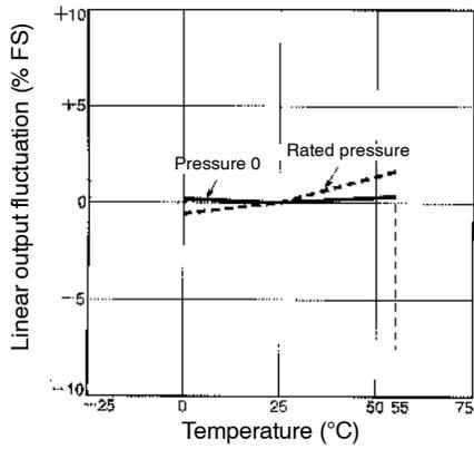
■ TEMPERATURE VS. OPERATING PRESSURE FLUCTUATION (TYPICAL)
