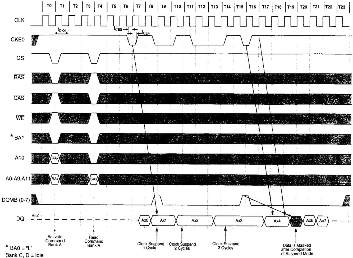
**Clock Suspension / DQMB During Burst Write**
