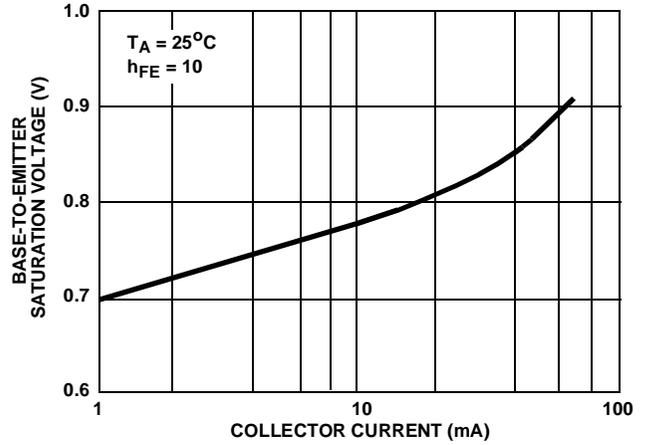
FIGURE 4. BASE-TO-EMITTER SATURATION VOLTAGE vs COLLECTOR CURRENT
