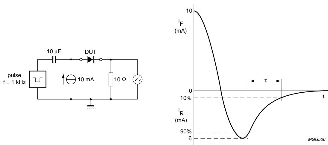
Input impedance of oscilloscope:  $1 \text{ M}\Omega$ ,  $22 \text{ pF}$ ;  $t_r \leq 7 \text{ ns}$ .
