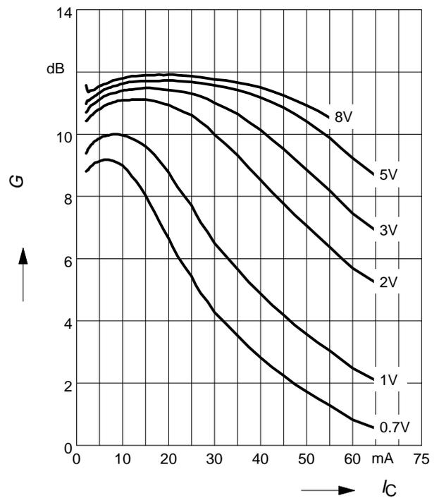
**Power Gain**  $G_{ma}, G_{ms} = f(V_{CE})$ :
