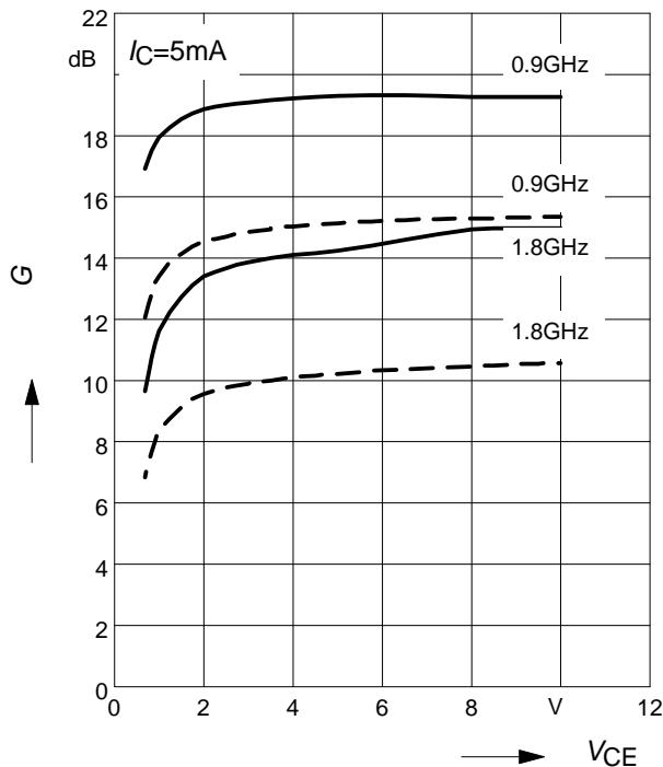
**Power Gain**  $G_{\text{ma}}, G_{\text{ms}} = f(f)$
