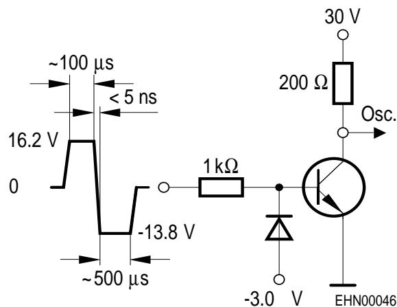
Oscillograph:  $R > 100\text{k}\Omega$
