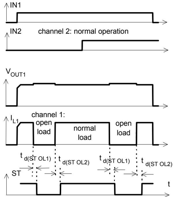
$t_{d(ST OL1)} = 30 \mu s$  typ.,  $t_{d(ST OL2)} = 20 \mu s$  typ
