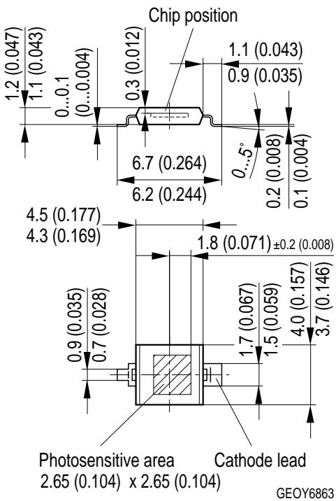
Maße werden wie folgt angegeben: mm (inch) / Dimensions are specified as follows: mm (inch).
