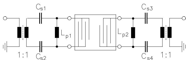
$$\begin{aligned} C_{s1,s2} &= 5,6 \text{ pF} \\ L_{p1} &= 33 \text{ nH} \\ L_{p2} &= 33 \text{ nH} \\ C_{s3,s4} &= 5,6 \text{ pF} \end{aligned}$$
