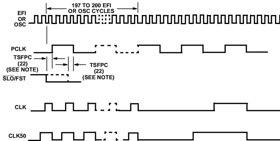
**FIGURE 16. FAST TO SLOW CLOCK MODE TRANSITION**
