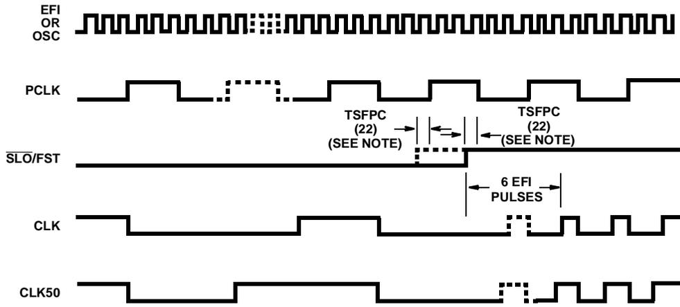
**FIGURE 17. SLOW TO FAST CLOCK MODE TRANSITION**
