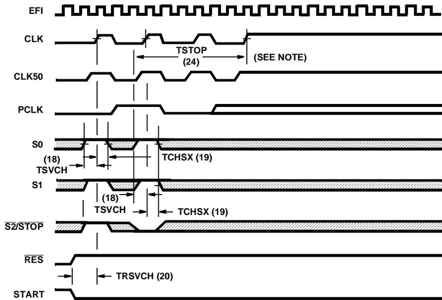
FIGURE 10. CLOCK STOP ( $F/\bar{C}$  HIGH OR  $F/\bar{C}$  LOW)
