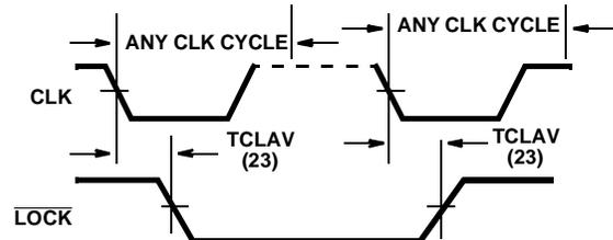
FIGURE 12. BUS LOCK SIGNAL TIMING (MAXIMUM MODE ONLY)
