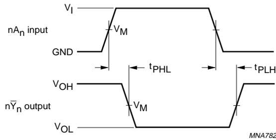
$V_M = 1.5\text{ V}$  at  $V_{CC} \geq 2.7\text{ V}$ .
