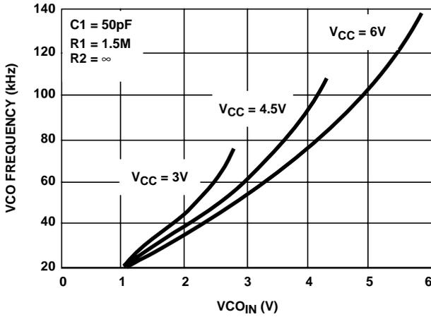
FIGURE 18. HC7046A TYPICAL VCO FREQUENCY vs VCO<sub>IN</sub>
