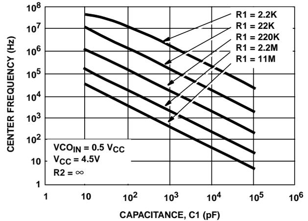
FIGURE 13. HC7046A TYPICAL CENTER FREQUENCY vs R1, C1
