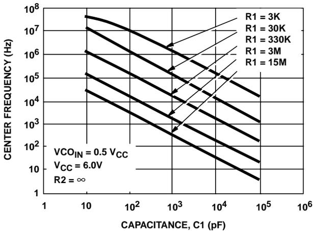
FIGURE 14. HC7046A TYPICAL CENTER FREQUENCY vs R1, C1
