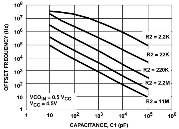
FIGURE 29. HC7046A OFFSET FREQUENCY vs R2, C1
