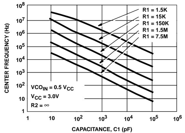
FIGURE 15. HC7046A TYPICAL CENTER FREQUENCY vs R1, C1
