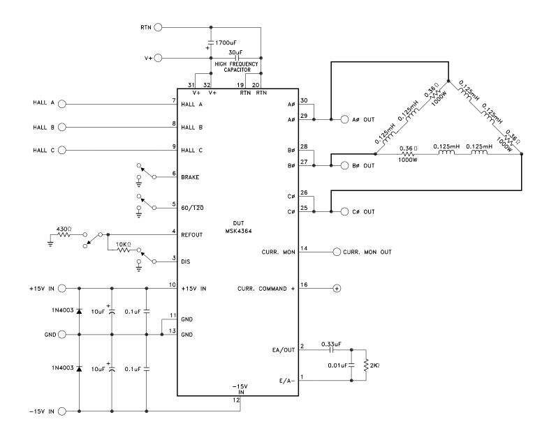
TYPICAL TEST SCHEMATIC
